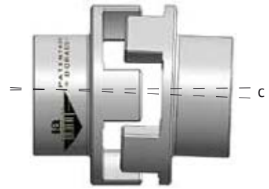
Desalineación ANGULAR Angular misalignments / Désalignement Angular
