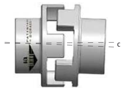
Desalineación ANGULAR Angular misalignments / Désalignement Angular
